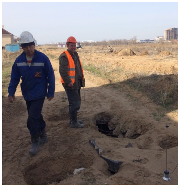
Сурет 36 - Жылу ағынын өлшеуге арналған құрылғыны тексеру барысы
