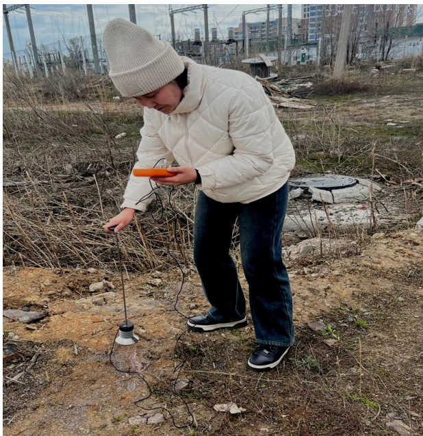
Сурет 36 - Жылу ағынын өлшеуге арналған құрылғыны тексеру барысы
