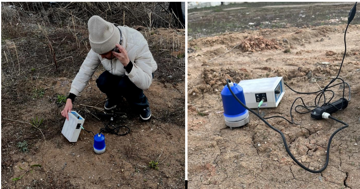
Сурет 42 - Зерттеу жұмыстары кезінде жылу желісінің ақау болған бөлігінің түсірілімі
